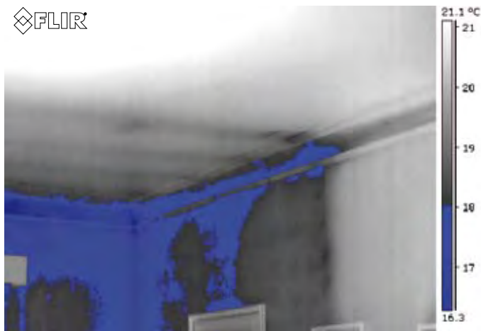
L'immagine mostra i riflessi su un muro interno (a destra) provenienti dalla finestra a sinistra.
